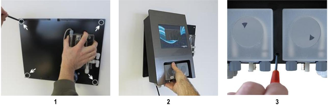
1. La plaque de base portant la chambre de mesure peut servir de gabarit de perçage : présentez-la à l'endroit prévu et marquez la position des trous sur le mur.
